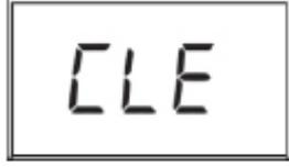
Reinigt die Waschkammer und entleert bad und Kessel
