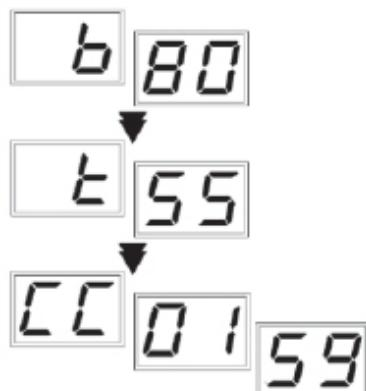
Drücken Sie bei eingeschaltetem Geschirrspüler fünf Sekunden lang auf PROGRAMM OPTION (2); die folgenden Informationen werden in dieser Reihenfolge angezeigt:
